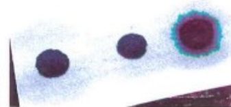
Aurèle bleue apparaissant à la périphérie de la tache (fin de l'adsorption du bleu)
