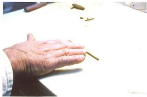
W_p : réalisation du rouleau de sol
