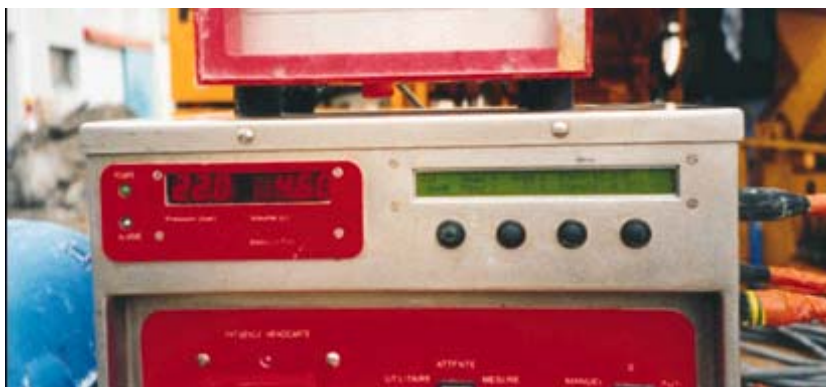
Injection : centrale de pilotage et d'enregistrement
