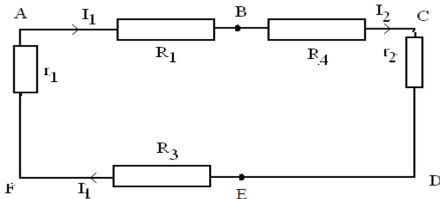
Entre B et E, les résistances  $(R_1 + r_1 + R_3)$  et  $(R_4 + r_2)$  sont associées en parallèle. Donc,
