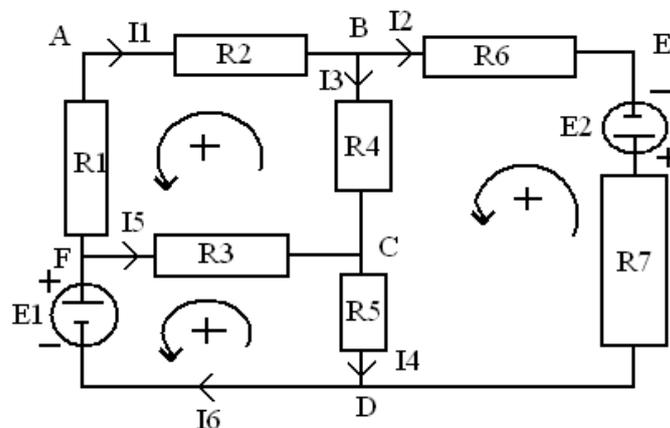
$E_1, E_2$  sont les f.e.ms du réseau et  $R$  les résistances. Si nous considérons la maille ABCFA, nous pouvons écrire  $(V_A - V_B) + (V_B - V_C) + (V_C - V_F) + (V_F - V_A) = 0$
