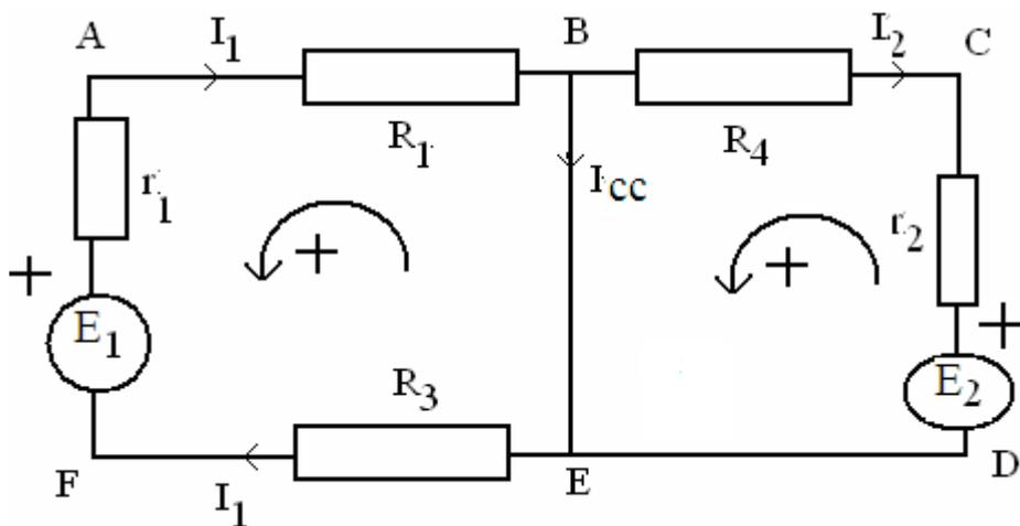
On en déduit le courant de court-circuit donné par (on annule la résistance  $R_2$  dans l'expression obtenue auparavant):
