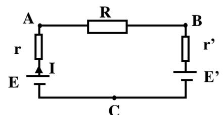
La d.d.p. aux bornes du générateur :  $V_A - V_C = E - rI$  et
