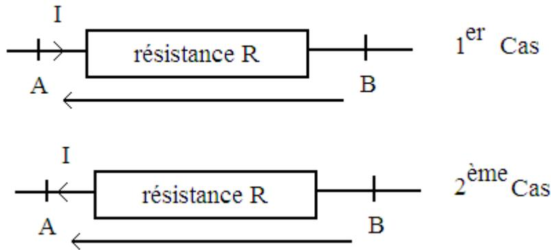
Pour le 1<sup>er</sup> cas, nous écrivons  $V_A - V_B = + R I$ , avec le sens choisi pour le courant la chute de potentiel représentée par une flèche allant vers les potentiels les plus élevés est égale à  $+ R I$
