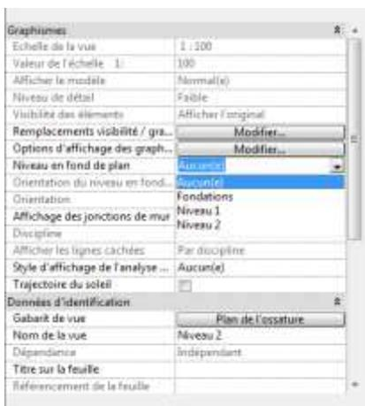
**Remarque :** Il est possible de régler la hauteur de coupe en utilisant la fonction Niveau en fond de plan.
