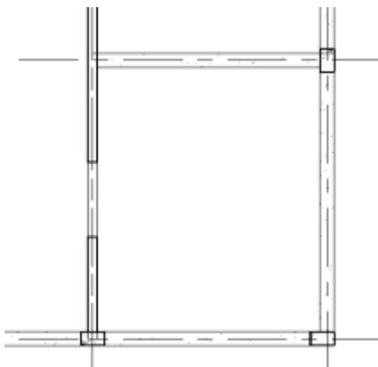
On remarque les traits renforcés sur les poteaux et les voiles, et les trait fort sur les poutres et les ouvertures.
